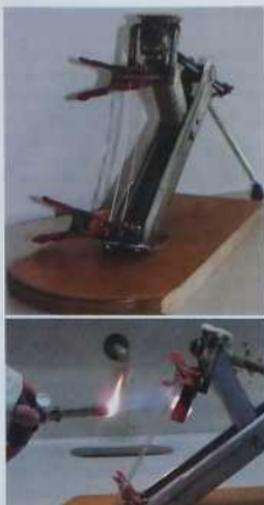
**Abb. 5:** Recken von PMMA-Streifen mit Hilfe eines Wagenhebers. Für eine bessere Standfestigkeit wurde der Wagenheber auf einer Holzplatte angebracht.
